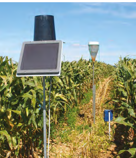
Station de mesure tensiométrique et pluviomètre ©APCA
