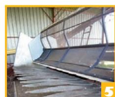
Lors de l'adaptation de la coupe à céréales, les rabatteurs doivent être partiellement obstrués pour éviter que les capitules ne s'accrochent et provoquent de la perte au sol. On ne conserve en général que 3 pales et on peut également les grillager ou ajouter des plaques à rabattement pour protéger la pointe des griffes. Les coupes spéciales "tournesol" sont en général équipées de rabatteurs adaptés et protégés par un bouclier.
