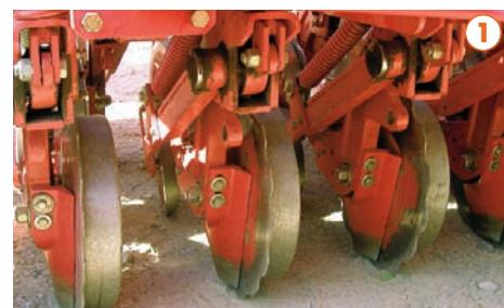
**Le système doubles disques** ②. Les disques sont de diamètres différents pour mieux pénétrer en terre et trancher les résidus végétaux ; le réglage de la profondeur (2,5 et 5 cm) se fait par le changement de la roue de jauge qui est montée sur un disque. Ce montage permet de limiter l'ouverture du sillon ; la fermeture de la ligne de semis est assurée par une mono roue biseautée ; un ressort permet d'augmenter la pression de fermeture.
