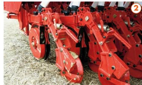
**Le système triples disques** ③. Un disque ouvreur plus ou moins ondulé est monté à l'avant des disques semeurs ; il travaille le sol sur une largeur de 3 à 8 cm. La pression de travail sur le disque peut atteindre 250 kg ; une sécurité ressort permet l'effacement en cas d'obstacle.
