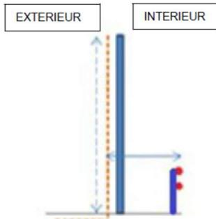
Figure 1 : clôture grillagée enfouie doublée par une clôture électrique intérieure
