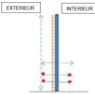
Figure 3 : clôture grillagée avec double électrification intérieur-extérieur
