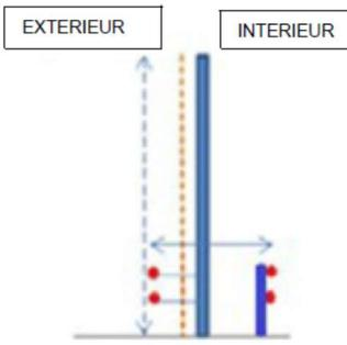
Figure 2 : clôture grillagée avec électrification extérieure doublée par une clôture électrique intérieure
