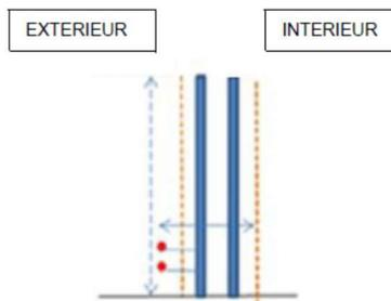
Figure 4 : clôture grillagée avec électrification extérieure doublée par une clôture grillagée intérieure
